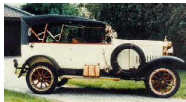
Typ: NSU 8/24 PS Phaeton Motor: 2.100 ccm / 24 PS Bauzeit: 1912-1925
