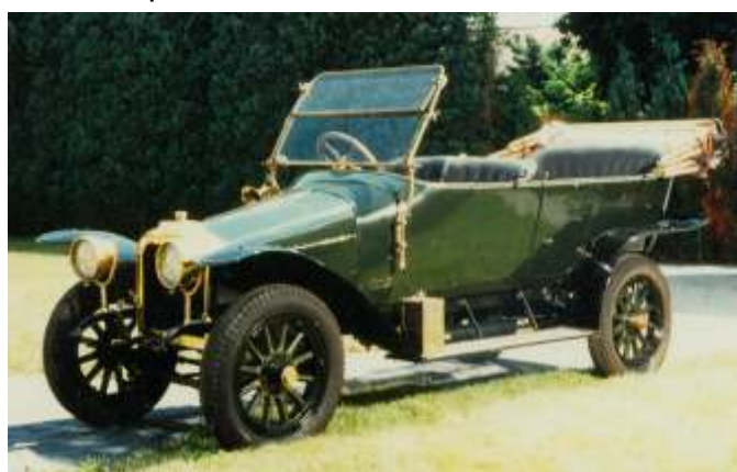
Typ: NSU 10/20 PS Doppel-Phaeton Motor: 2.608 ccm / 20 PS Bauzeit: 1907-1911
