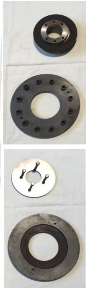
Dies sind die Einzelteile des frontseitig angebauten Kurbelwellen-Dämpfersystems. 2 federbelastende Schwungscheiben sind gegen 2 Reibscheiben gepresst.
